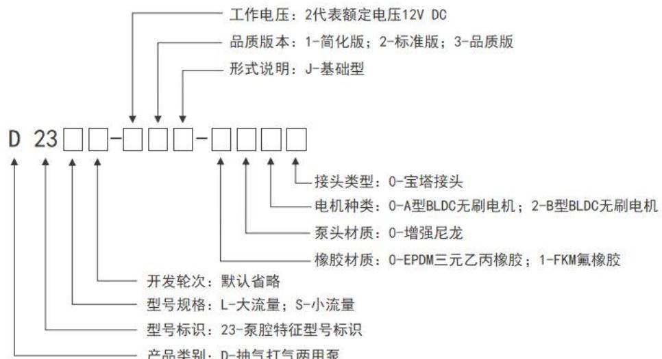
示例 1: D23L-21J (D23 大流量泵, 12V 电压基础型简化版)
