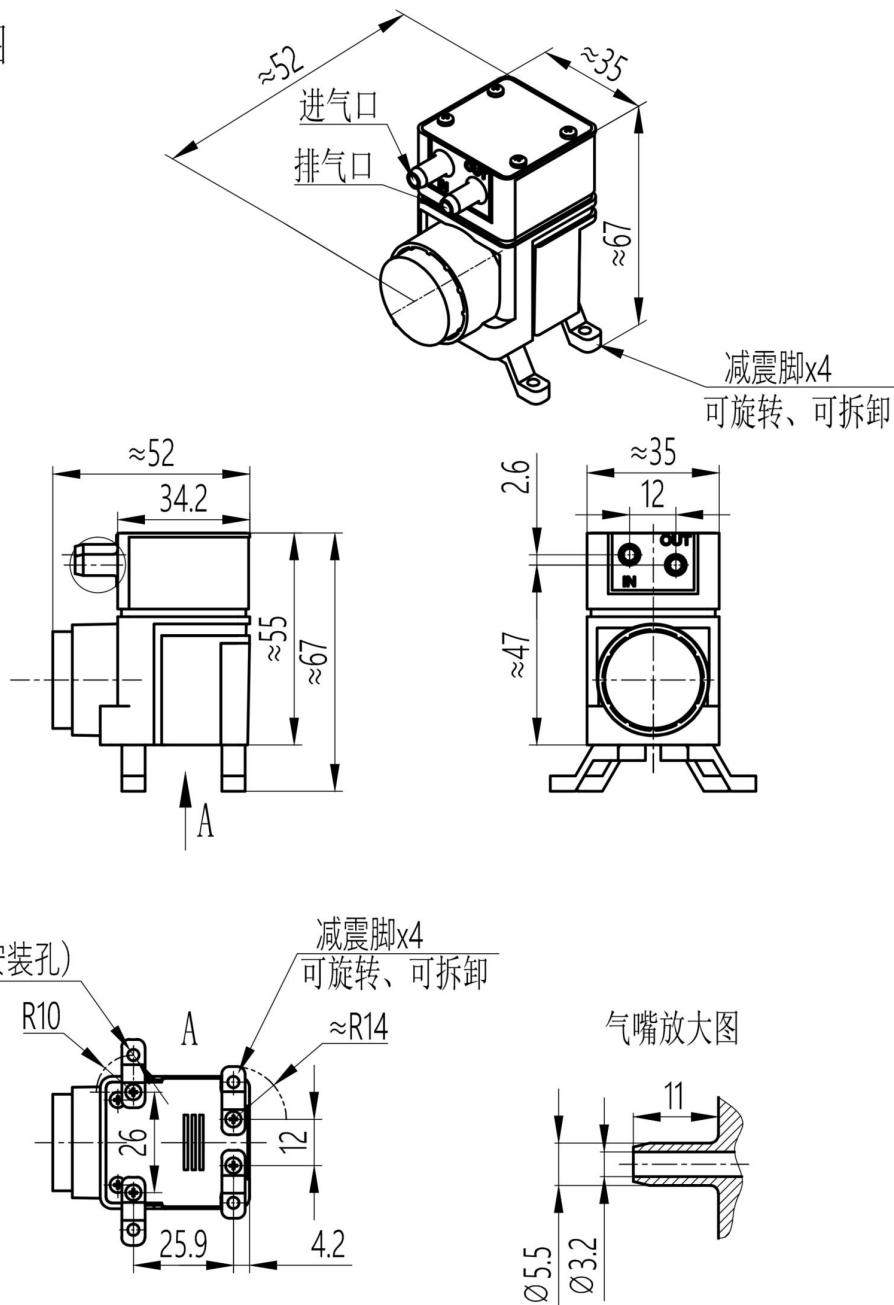
**安装说明:** 1、泵上自带的螺钉不能拆卸，会损坏泵；
