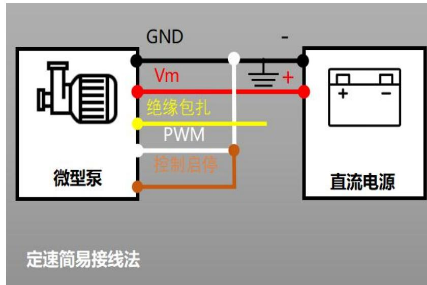
当需要使用 PWM 调速功能时，需要使用支持 PWM 信号输出的信号源(函数信号发生器、MCU、PLC 等控制器），将信号源输出连接白色 PWM 输入线缆，并将 PWM 信号源地与直流电源地进行连接，黄色线绝缘包扎。
