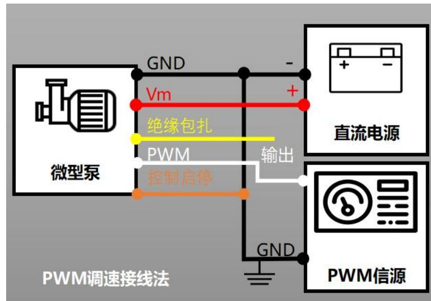
当需要使用 PWM 调速功能并通过 FG 信号监控泵运转情况或进行反馈控制时，需要使用支持 PWM 信号输出、FG 信号输入和起停控制的上位控制器（MCU、PLC、上位机等控制器），将信号源输出连接白色 PWM
